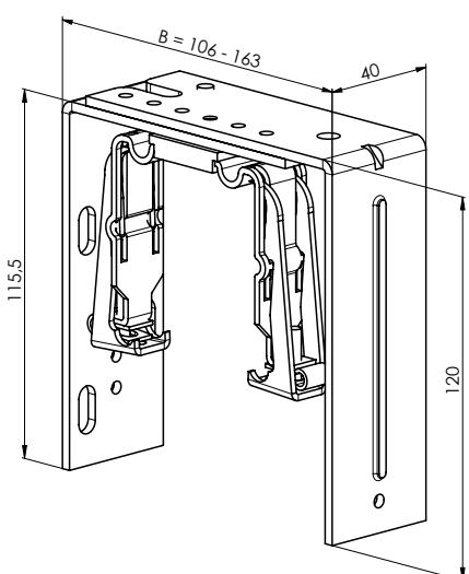
Support-double mécanique - réglable, longe 165 – 223 mm
