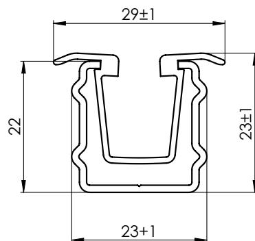
La coulisse encastrée est préparée de deux pieces (300 mm d'un haut de coulisse) et elle est jointe par la gomme pour pouvoir y bien mettre les embouts de coulisses et la bien mettre dans sa couverture. La gomme de coulisse ne fait qu'une seule piece.
