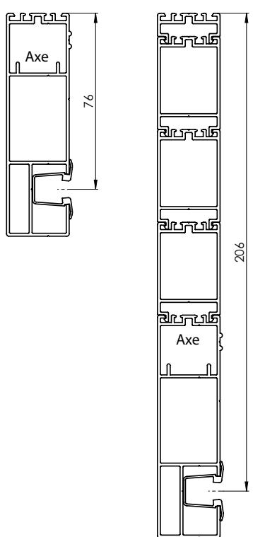
Profil de base P 080 Élargissement maximal de profil de base P 080
