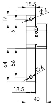
Pour le profil 40x40 mm, la distance minimale entre l'axe du guidage et la surface de fixation est de 70 mm !
