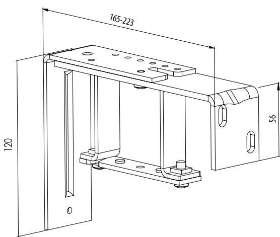
**Support double - fixe avec support en aluminium 132,5 mm**
