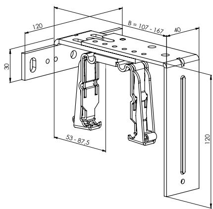
Support reglable - mecanique 162 - 222 mm
