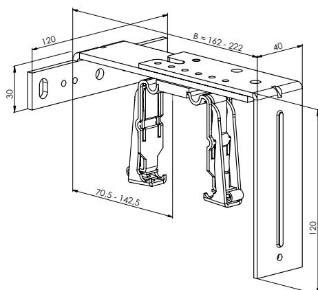
Support reglable - mecanique 217 - 277 mm
