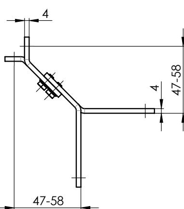
Pour le profil 50x50 mm, la distance minimale entre l'axe du guidage et la surface de fixation est de 80 mm !
