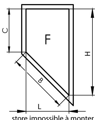
Largeur minimale pour manoeuvre par moteur est 600 mm.
