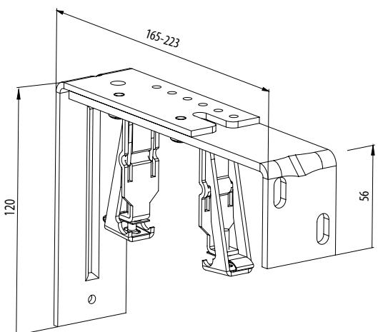
Support-double mécanique - fixe 132,5 mm
