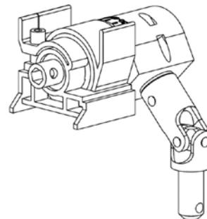
Treuil avec sortie à 6p pour commande par manivelle
