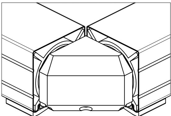
Détail d'assemblage des lames et des coulisses inférieures de l'angle
