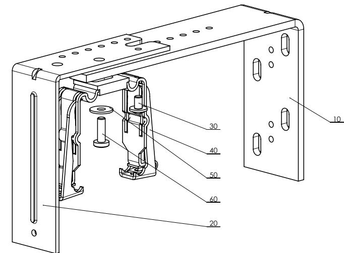
Support reglable double - mecanique 256 – 318 mm
