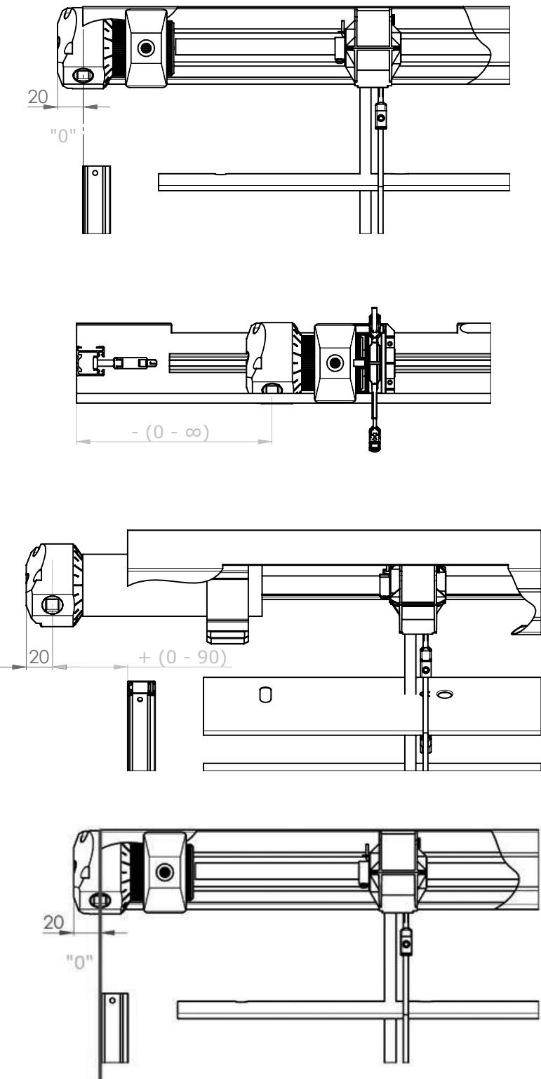
La position du treuil (déplacement possible) du boîtier dépend de l'emplacement concret du cadre de la fenêtre, de l'embrasure. La décalage du treuil est la distance de l'axe de boîtier de réduction du bord extérieur de la lame dans le cas de commande par la cable en acier.
