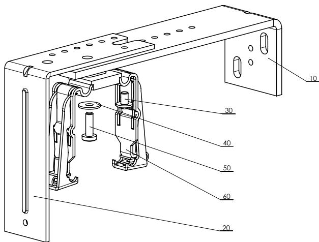
Support reglable - mecanique 256 – 318 mm
