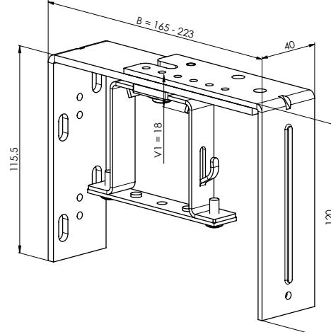
Support reglable - mecanique 107 - 167 mm
