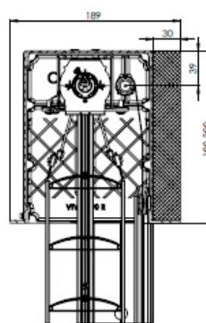
Coupe de store autoportant encastré Viva (Préparé pour le polystyrène de côté frontal + Alutermo quattro 10 de côté arrière)
