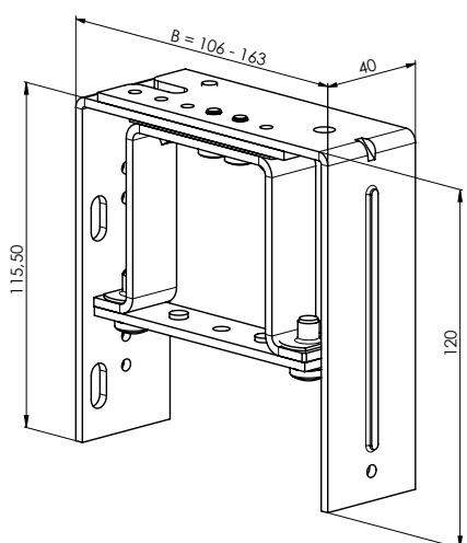
**Support double - réglable, long avec support en aluminium 165 – 223 mm**
