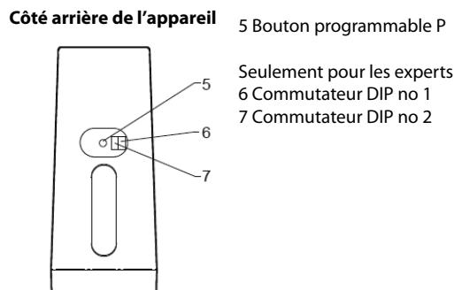
On enlève le couvercle en caoutchouc situé côté arrière de la télécommande et on fait passer le commutateur no 2 situé sur la télécommande à la position OFF.
