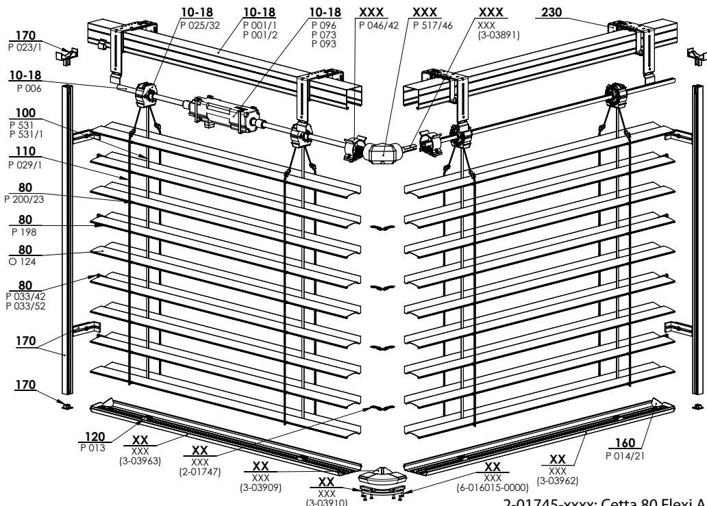
Détail d'assemblage des canaux supérieurs
