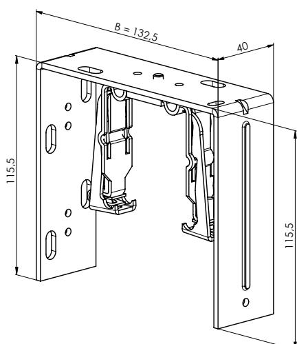
Support-double mécanique - réglable, court 106-163 mm
