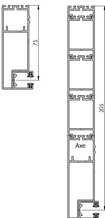
Profil de base P 081 Élargissement maximal de profil de base P 081
