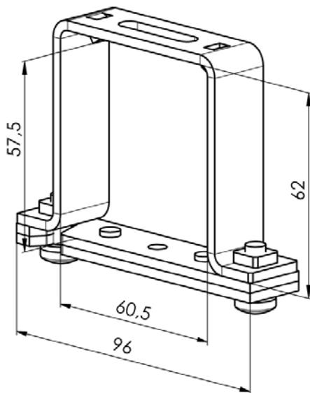
Étrier du boîtier FE pour guidage par cable (2-00685)
