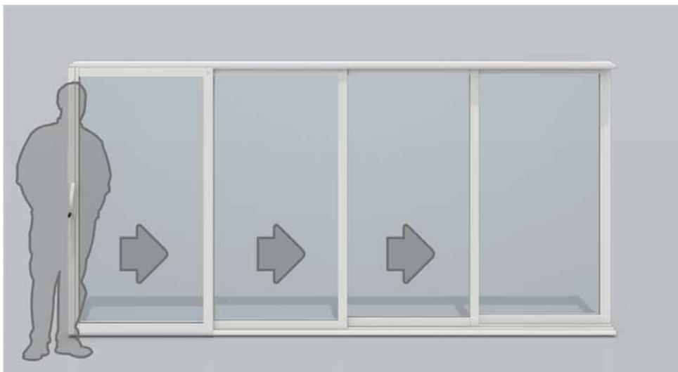
Ouverture vers l'extérieur (rideau) – deux vantaux situés le plus au centre sont le plus près, on les équipe d'une poignée (sur la commande, on peut indiquer « poignée à droite et à gauche » ou « dépôt des vantaux vers l'extérieur »).
