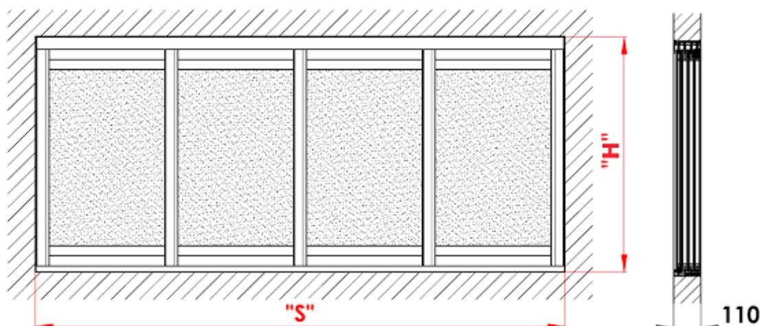
Pour les systèmes coulissants ARTOSI SLIDE PANELS, on saisit en général les plus petites valeurs mesurées de la largeur et de la hauteur de l'ouverture où le système coulissant sera installé. La profondeur minimale du cadre de la structure portante est de 110 mm.
