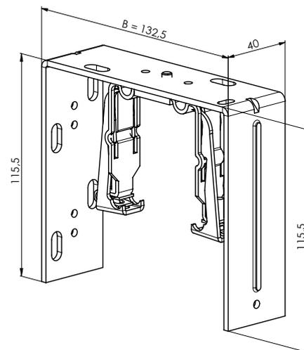
Support-double mécanique - réglable, court 106-163 mm
