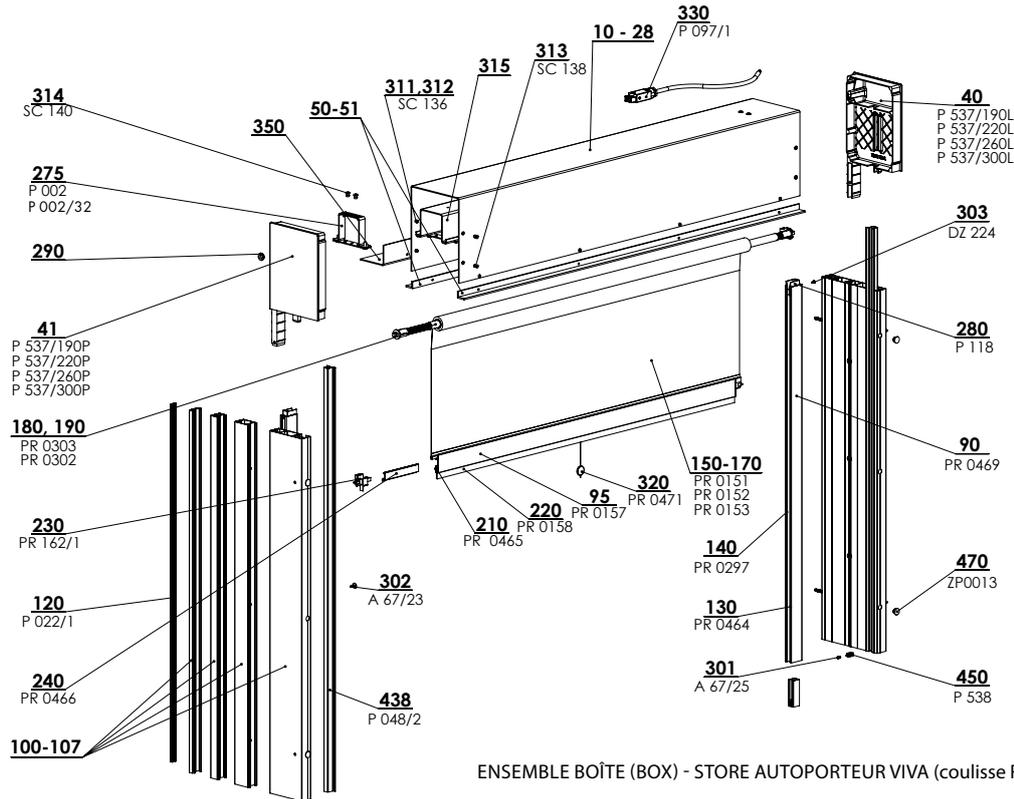
Box VIVA pour plusieurs stores – dans un box, on peut installer 2 stores et 2 moteurs (2-01016-XXXX) au maximum
