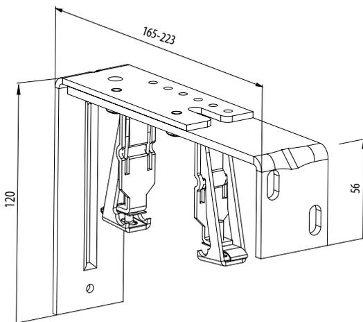
Support-double mécanique - fixe 132,5 mm
