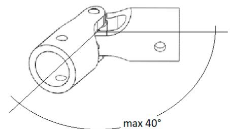
L'angle max. pour un joint est de 0-40 degrés.
