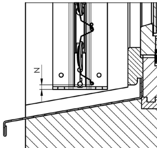
L'écart entre le bord inférieur de la dernière latte et extrémité du guide-chaîne N =  $10 \pm 5$  mm
