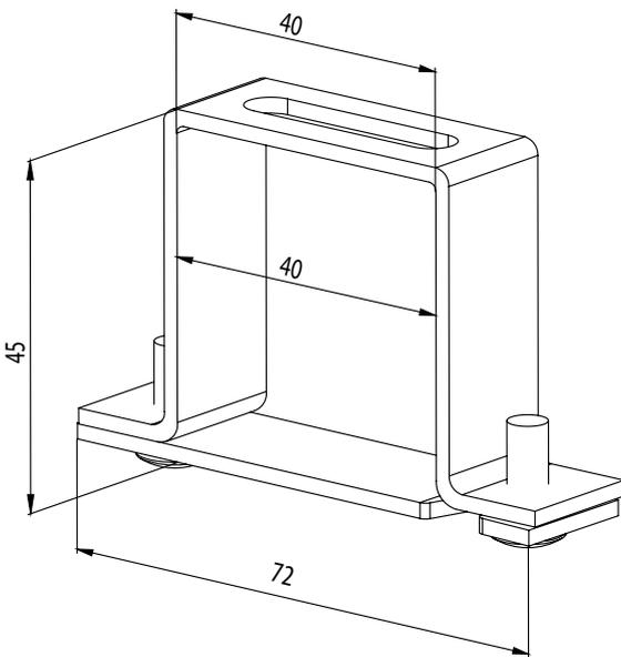
Support fixe C50 pour fixation avec le lambrequin
