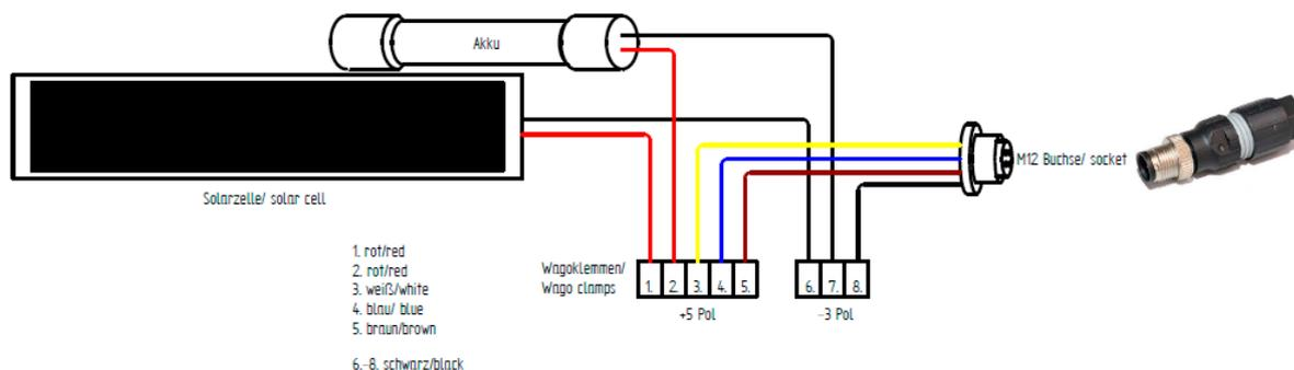
1) connexion entre le panneau solaire et le récepteur
