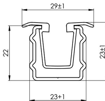
La coulisse encastrée est préparée de deux pièces (300 mm d'un haut de coulisse) et elle est jointe par la gomme pour pouvoir y bien mettre les embouts de coulisses et la bien mettre dans sa couverture. La gomme de coulisse ne fait qu'une seule pièce.
