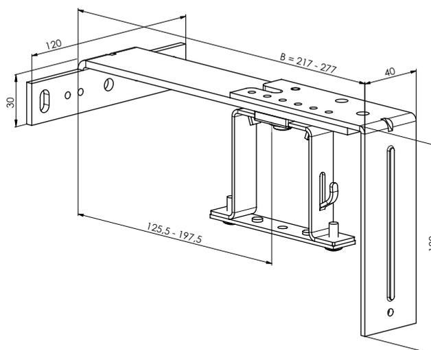
Support réglable - mécanique 206 – 268 mm
