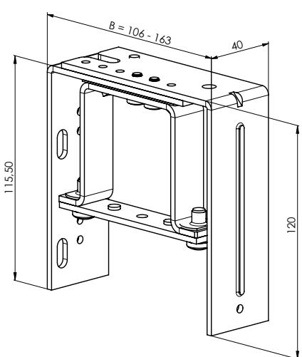
Support double - réglable, longe avec support en aluminium 165 - 223 mm
